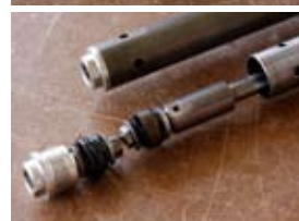
バネレート変更とともに考えたいダンピング調整だが、ペガサスではスタンダードフォークのカートリッジ化(写真右)を推奨。但し、ダエグはカートリッジが非分解(写真左上の奥)のため、現在対策案を検討中。ダエグ以前のモデルは分解可能(写真左下)のため、内部のシム組み替えを行っている。
