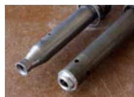
クラッチスプリングは、素材から探し独自に製作を依頼しているスペシャルパーツ。どこで効き始めるか、その設定に重要な役割を果たす。
