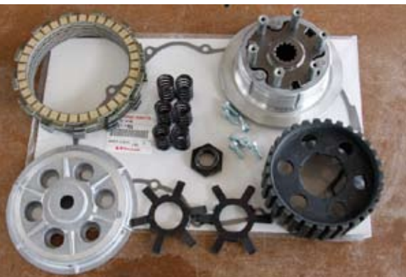
ペガサス製バックトルクリミッターキット。右側の2点、分割仕様のセンターハブと、中央のクラッチスプリングがポイントだ。写真のクラッチ板9枚キットで価格は9万4500円。
