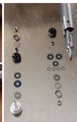
バネレート変更とともに考えたいダンピング調整だが、ペガサスではスタンダードフォークのカートリッジ化(写真右)を推奨。但し、ダエグはカートリッジが非分解(写真左上の奥)のため、現在対策案を検討中。ダエグ以前のモデルは分解可能(写真左下)のため、内部のシム組み替えを行っている。
