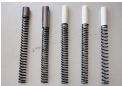
バックトルクリミッターキットを組み込むと、走りにアグレッシブさが増すため、次に考えたいのはサス。まずはバネレートだが、写真はZRXのフォークスプリング比較で、左から1100用(0.8kg/mm)、1200前期(0.85)、1200後期(0.85)、ダエグ用(約0.87)、ペガサスオリジナル(0.9)。ペガサスは、よく動かしつつ奥で踏ん張る仕様。
