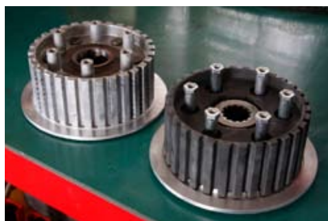
右手前がキットのセンターハブ、左奥がノーマルパーツ。一体型のノーマルに対し、キットは黒とシルバーの部分が分割構造となっている。ここで意図的なズレを作り力を逃がす。
